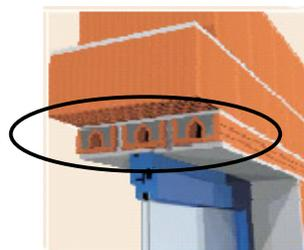
**Domeniu de utilizare:** element de constructie prevazut in partea superioara a golurilor pentru usi, ferestre etc, cu rol de sustinere a portiunii de zidarie de desupra acestora.
